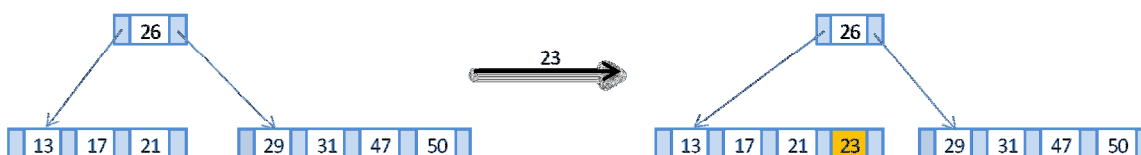
Slika 80: Vstavljanje podatka s ključem 23 v B-drevo
